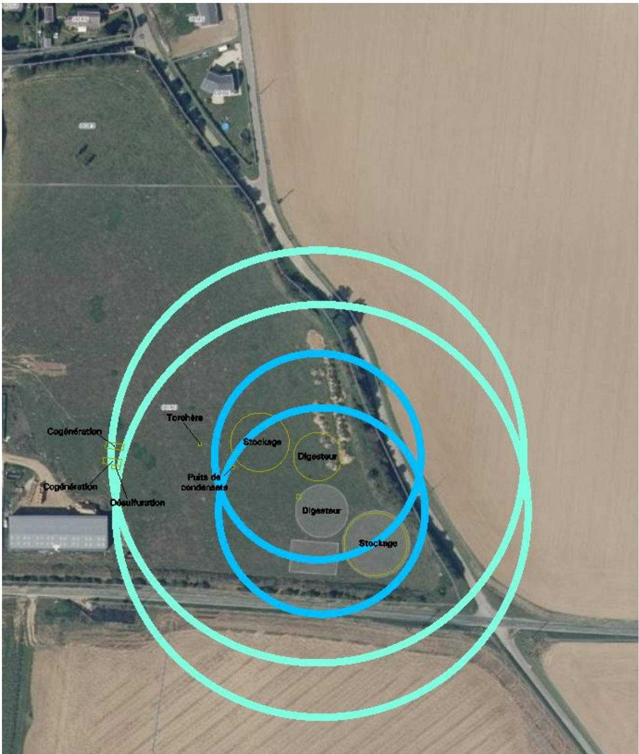
Figure 1 : Cartographie du Scénario 1 : explosion dans un digesteur ou son gazomètre
